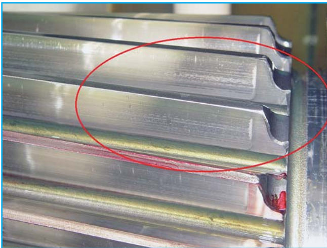
Abbildung 1: Am Ritzel der Zwischenwelle ist Graufleckigkeit im Zahnfußbereich vorhanden, die sich zum großen Generator hin verstärkt.
